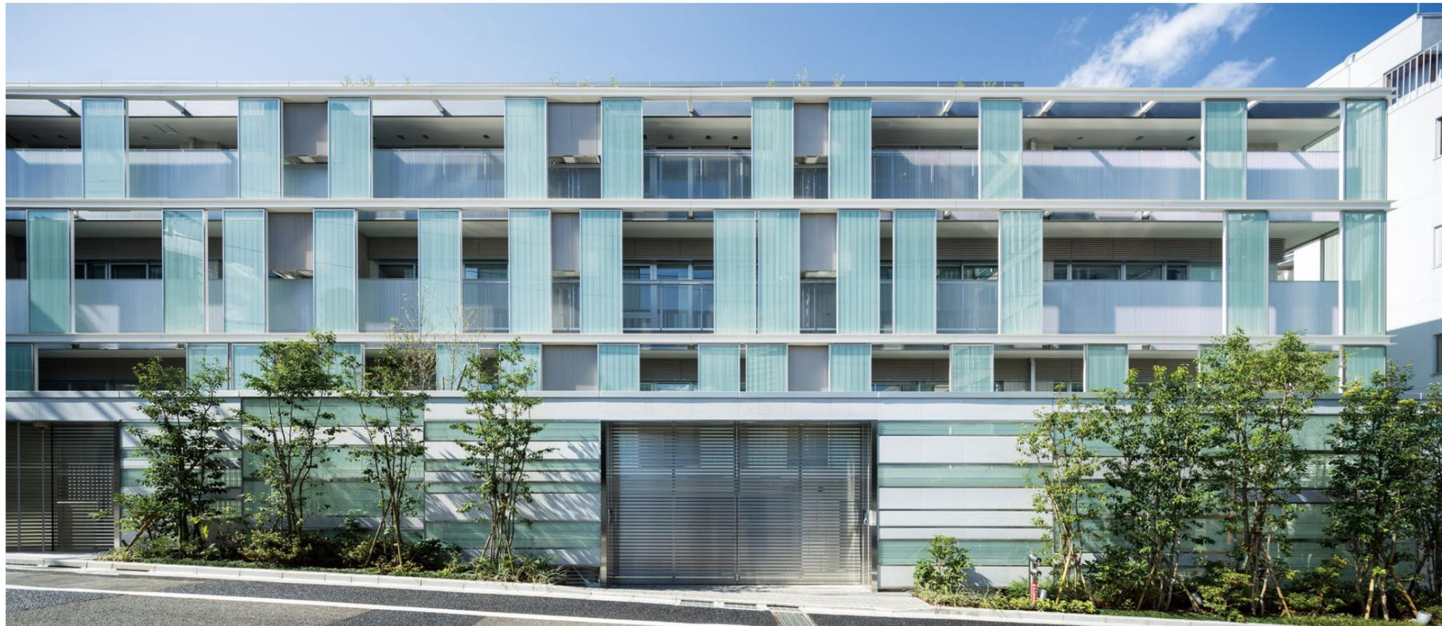
印花玻璃幕墙，石材，金属，格子扶手等等素材所形成的平面进行重叠，构成一种既封闭又开放的多层次立面
