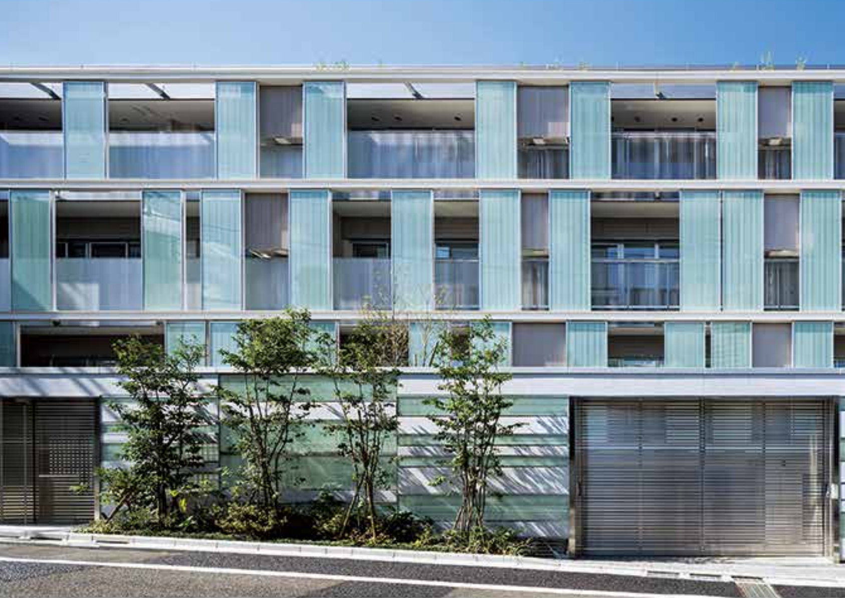
上／石、ガラス、金属、タイル等の素材のレイヤーを重ねることで、閉じながら開く重層的なファサードを構成 下／広大な国立科学博物館附属自然教育園に接した敷地
